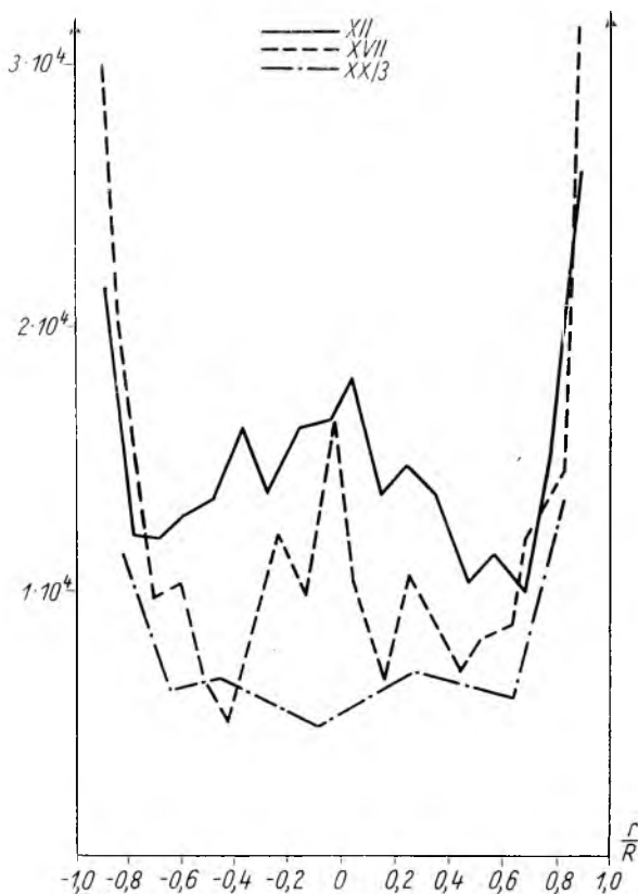
19-3. ábra. A diszlokáció-sűrűség eloszlása az átmérő mentén, a tárgyalt módszerrel húzott egykristályokon
