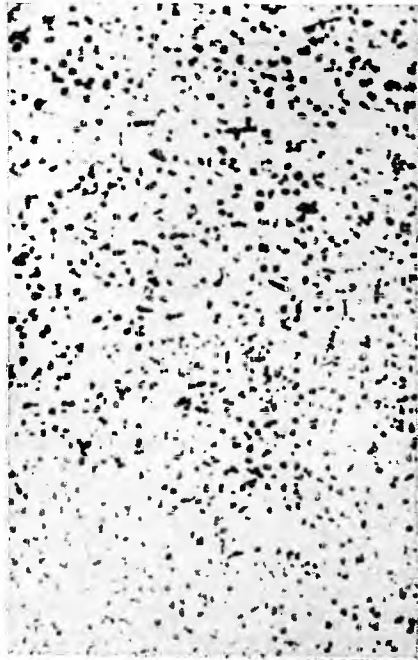
23-5. ábra. 90/10%-os összetételű AgCdO érintkezők szemcseszerkezetének mikroszkópi felvétele
