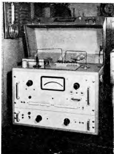
3-9. ábra. Ricu—Vakutronik elektronikus megohmmérő, amely a tetején elhelyezett mérő-platóval és a lezárható (az ábrán felnyitott) fedéllel kondicionált térben történő felületi ellenállás mérésekhez használható
